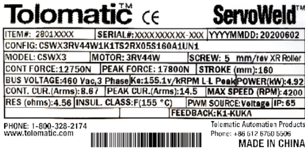
Figura 2.3: Etiqueta de identificación del actuador ServoWeld CSW y CSWX para actuadores fabricados en China.
