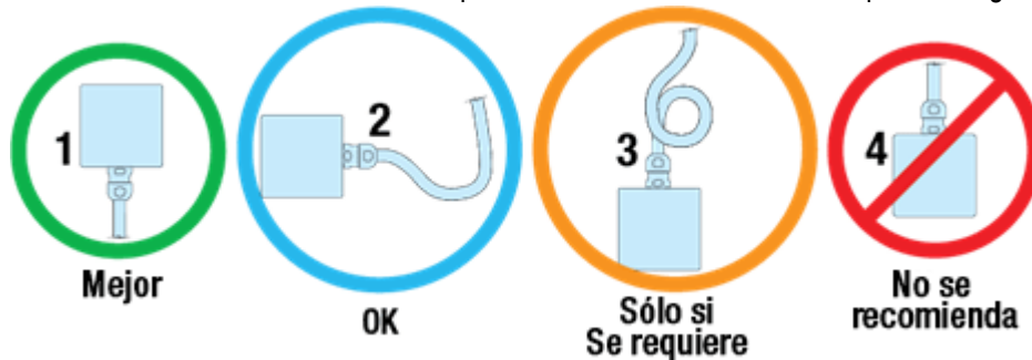
Figura 5.1: Trazado recomendado del cableado de ServoWeld.
